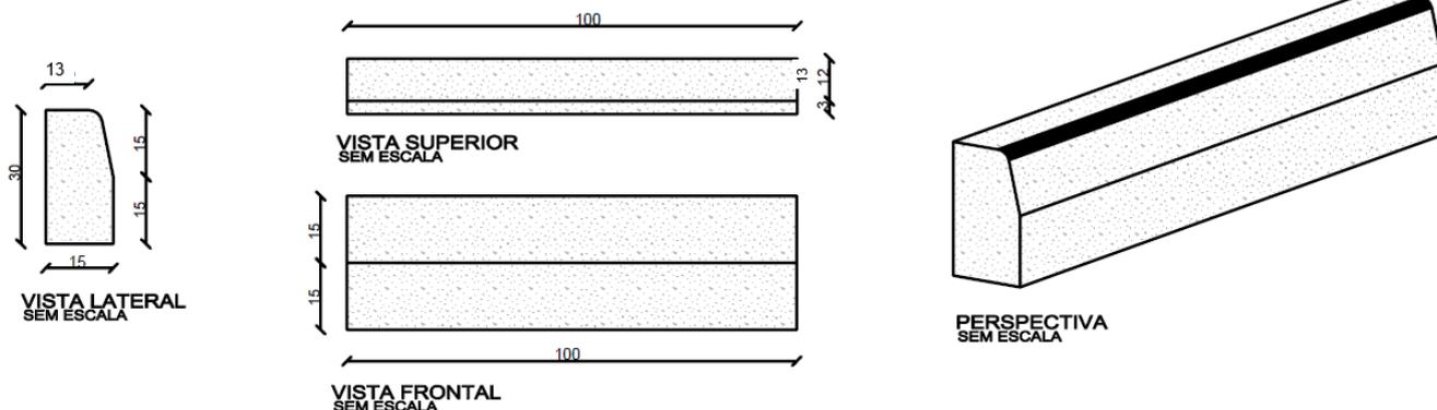
O meio fio será instalado em toda extensão das calçadas de passeio, e será rebaixado junto às faixas de pedestres, conforme dimensões especificadas em projeto, onde serão executadas rampas de acessibilidade, que seguirão as orientações da NBR 9050 (ABNT, 2020).
